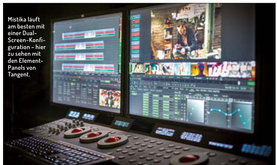
Mistika läuft am besten mit einer Dual-Screen-Konfiguration – hier zu sehen mit den Element-Panels von Tangent.
